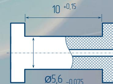
5000 витков, провод  $\varnothing$  0,063 мм
