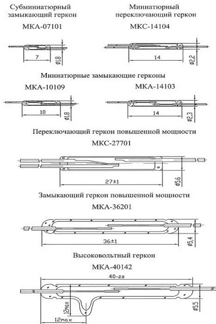
Рис. 1. Основные конструкции магнитоуправляемых герметизированных контактов (герконов)
