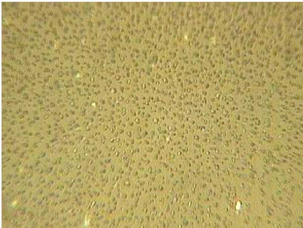
Рис. 6. Участок внутренней поверхности стеклобаллона геркона с «белым налетом» ( \times 1000 , зона 3).
