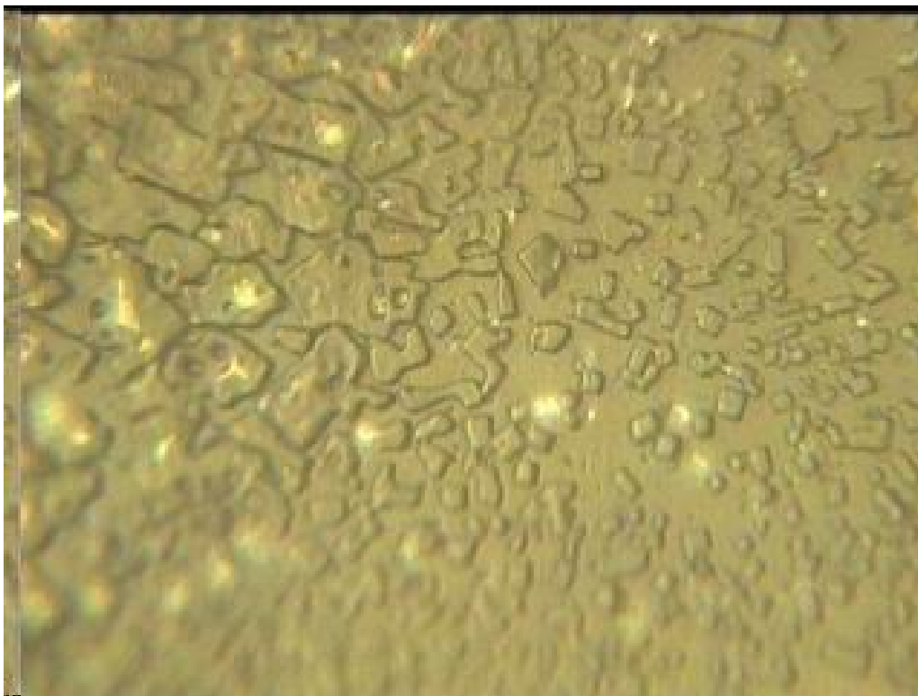
Рис. 4. Участок внутренней поверхности стеклобаллона геркона с «белым налетом» ( \times 1000 , зона 1).
