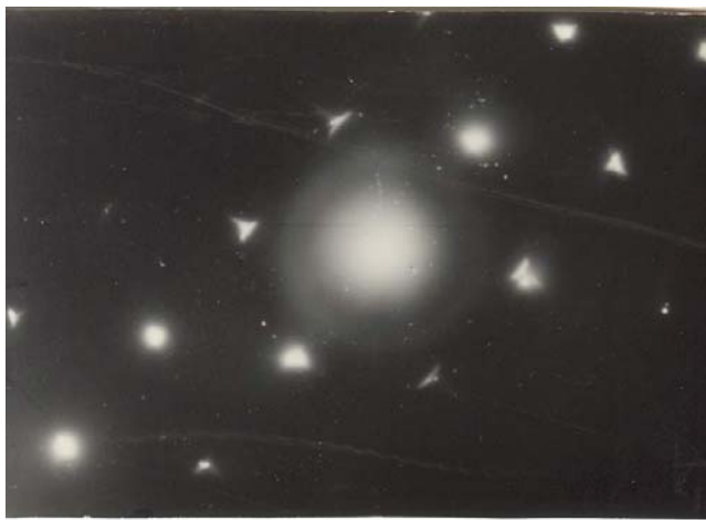
Рис. 10. Монокристаллическая вольфрамовая фольга, прокаленная в вакууме постоянным током ( P = 10^{-8}-10^{-9} Торр, T = 2100 К, t = 10 ч) при наблюдении в электронном микроскопе: а) дефекты вблизи поверхностной структуры; б) электронограмма данного участка поверхности; в) форма рефлекса (110)
