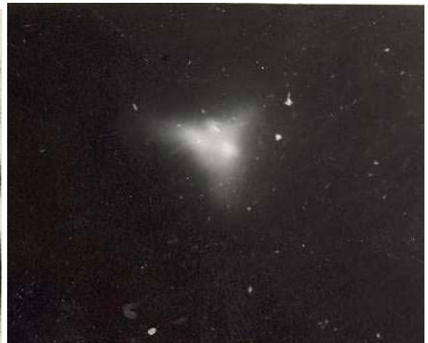
Рис. 10. Монокристаллическая вольфрамовая фольга, прокаленная в вакууме постоянным током ( P = 10^{-8}-10^{-9} Торр, T = 2100 К, t = 10 ч) при наблюдении в электронном микроскопе: а) дефекты вблизи поверхностной структуры; б) электронограмма данного участка поверхности; в) форма рефлекса (110)
