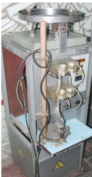
Рис. 1. Автомат затаривания контакт-деталей ОМ-117200000 с щелевым ориентатором
